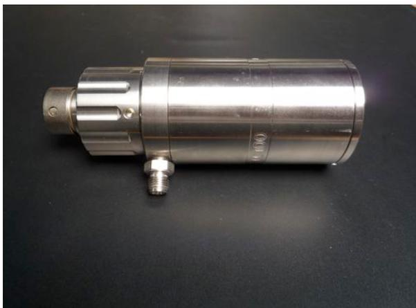
Nachdem Sie den Sensor von der Leitung genommen haben, schrauben Sie die Schutzkappe ab. Entfernen Sie die Schutzkappe mit Vorsicht, ohne den Grill und die Unterlegescheiben im Inneren zu verlieren.
