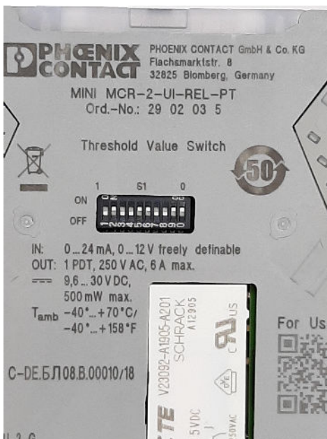
Abb. 28 Phys. DIP Schalterkonfiguration Funktion „Niedrig“ Alarm. DIP Schalter 3, 5, 6, 9, 0 aktiviert 'ON'
