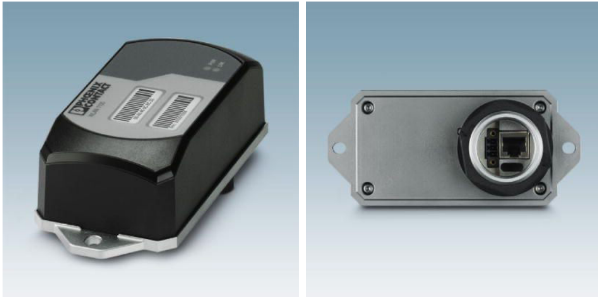
Abbildung 34 WLAN Access Point, Client mit zwei internen Antennen (MIMO) für die Einlochmontage, IP54, WLAN 802.11 a, b, g, n, Frequenz: 2,4 GHz, 5 GHz (inkl. DFS-Kanäle), Anschlüsse: COMBICON 9 ... 32 V DC, RJ45: für LAN, Web, http/https, Befehlszeilenschnittstelle
