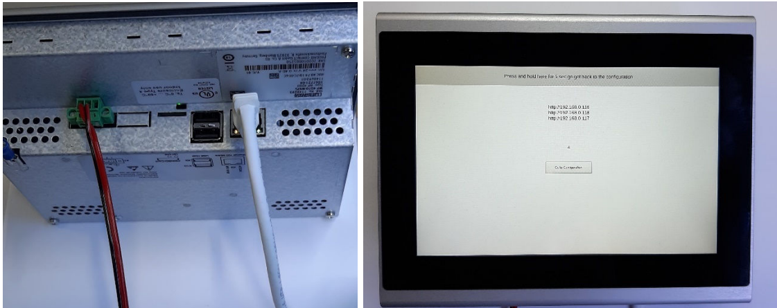
Abbildung 9 Kabelverbindungen zum externen Display und Aktivierung der Konfigurationsseite beim Einschalten.
