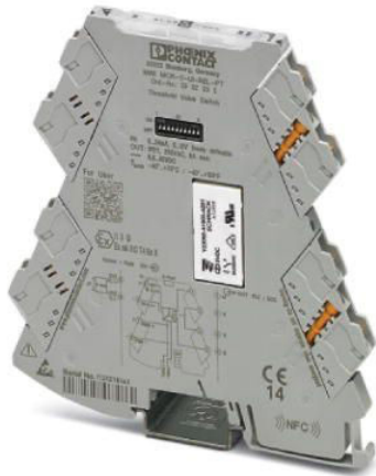
Abbildung 37 Grenzwertschalter. Universell konfigurierbarer Grenzwertschalter mit PDT-Relaisausgang und Steckanschlusstechnik zum Schalten analoger Grenzwerte. Konfigurierbar über DIP-Schalter oder Software. Push-In-Verbindungstechnologie, Standardkonfiguration.
