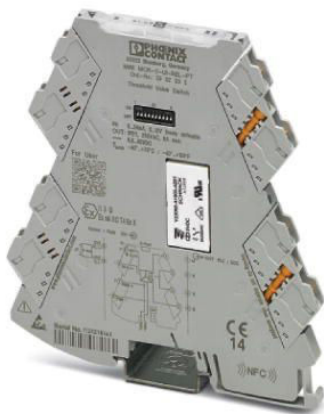
Abbildung 21 Grenzwertschalter mit Wechsler-Relaisausgang zur Überwachung der analogen Grenzwerte des Sensors. Die Sensorwäsche wird durch die DIP-Schalter-Stellung bei einem bestimmten mA-Grenz-Wert aktiviert. Das Relais wird je nach Wahl geschlossen oder geöffnet.
