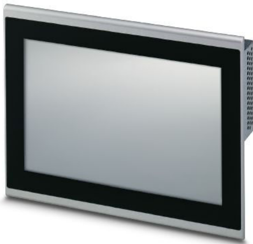
Abbildung 35 Externes 7-Zoll-Touch-Display für Schalttafeleinbau und 4 Sensoren. Touchpanel mit 17,8 cm TFT-Display (projektiv-kapazitiv (PCAP)), 1280 x 800 Pixel (WXGA), 16,7 Millionen Farben, Arm® Cortex®-A53, 4 x 1,2 GHz, 2x USB-Host 2.0, 1 x Ethernet (10/100 Mbit/s), RJ45, Yocto/Linux und Anwendersoftware: Chromium Browser (Bussystem: ohne)
